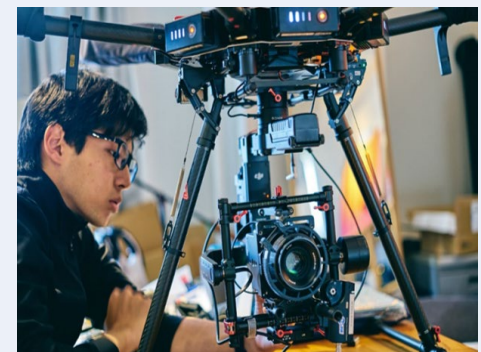
▲測量・点検用ドローンのメンテナンスをしている様子
