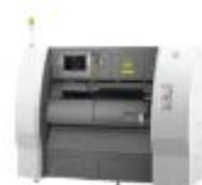
金属粉末をレーザーにより焼結させ任意の3次元形状の精密部品を製作
