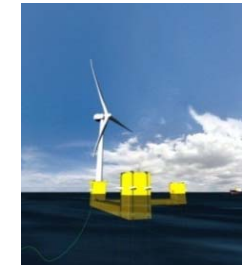
V字型セミサブ浮体
