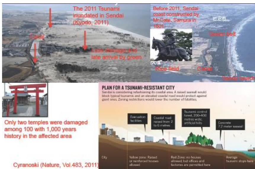
図-2 東日本大震災での仙台平野沿岸での被害と復興プラン（多重防御の考え）
