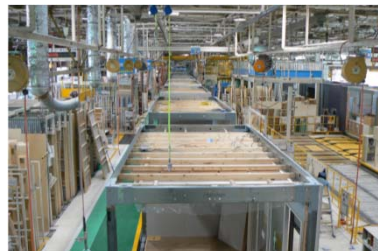
住宅ユニット製造ライン
