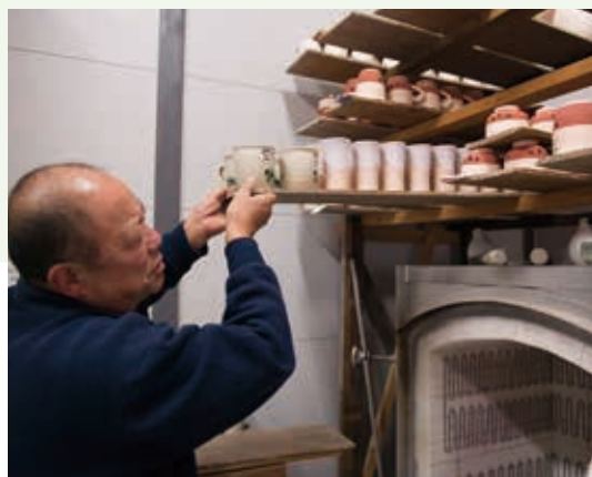
成形・乾燥させた陶器は、900～950℃で素焼きした後、「浸しかけ」、「回しかけ」、「流しかけ」などの方法で釉薬をかけ、1,250～1,300℃の高温でじっくりと本焼きしていく。
