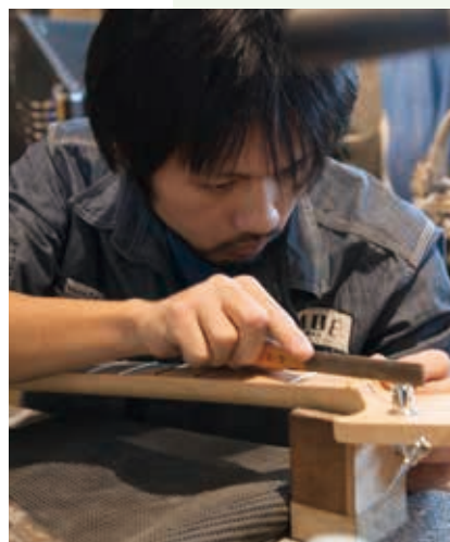
ネック部にヤスリをかける工房スタッフ。その作業の一つひとつがギターの音質に関わる重要な要素。丁寧に慎重な作業が続く。
