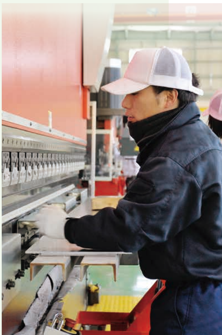
左／住宅用鋼製建材や太陽光発電システムの架台を製造する機械。上／工場の屋根や敷地内に設置された太陽光発電モジュールで、工場の稼働に必要な電力の全てを賄っている。
