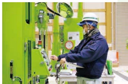
川内第一工場にある「ルナウェア」の製造機械。蓄光タイルや蓄光石、蓄光ビーズなど、さまざまな形状の「ルナウェア」が製造できる。
