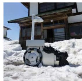
遠隔操作型除雪ロボット
