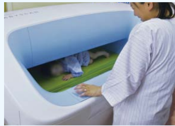
従来のホールボディカウンターと異なり、横になった状態で検査を受けることができるため、乳児も容易に検査できる。
