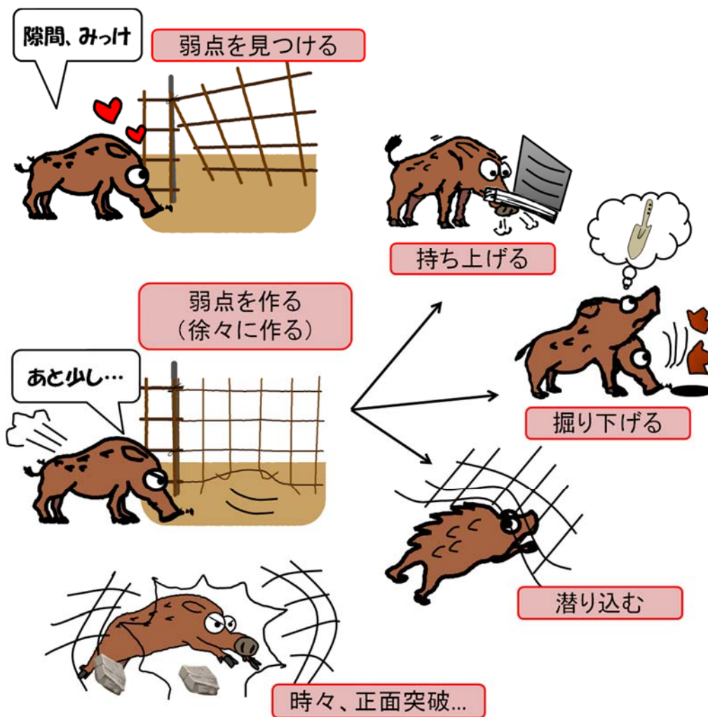
図IV-21 イノシシの突破戦略 これらのイノシシの行動心理を考慮して点検を行う
