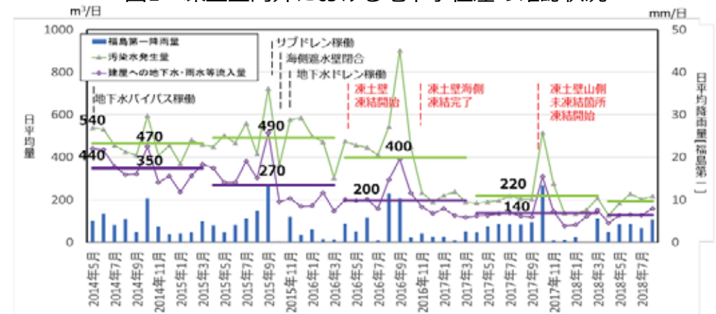
図2 汚染水発生量と建屋流入量の低減状況
