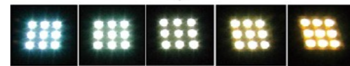
発光中心イオン β-SiAlON phosphor α-SiAlON phosphor CaAlSiN 3 昼光色 昼白色 白色 温白色 電球色 出典：NIMS HP
