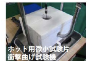
恒温槽 (0°C ~ -190°C まで) 図7 微小曲げ/引張試験機器
