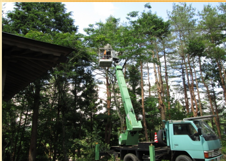
高所作業車による枝打作業
