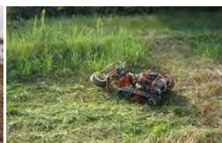
法面用除草ロボット
