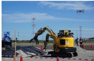
2重旋回機構による重作業と精密作業の両方が可能な双腕ロボット。有線ドローンからの俯瞰映像により、遠隔操作を支援
