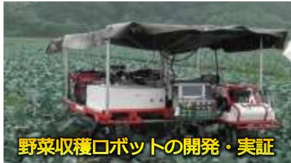
野菜収穫ロボットの開発・実証
