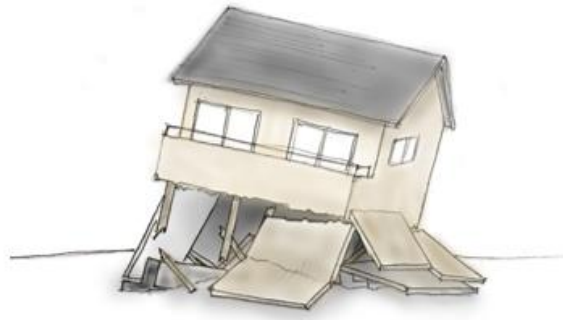
（基礎及び1階部分が崩れた住宅）
