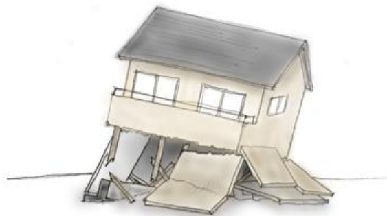
(基礎及び1階部分が崩れた住宅)
