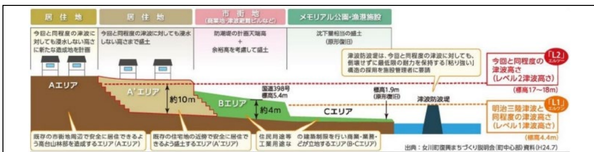
図表 5-6-22 景観や自然環境に配慮した堤防デザイン例(女川町)
