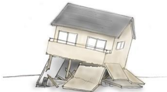
(基礎及び1階部分が崩れた住宅)
