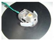
配管検査用“小型ロボット”の開発(豊洋電子精機×東北学院大学)
