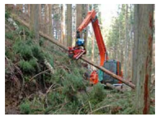
高性能林業機械による間伐
