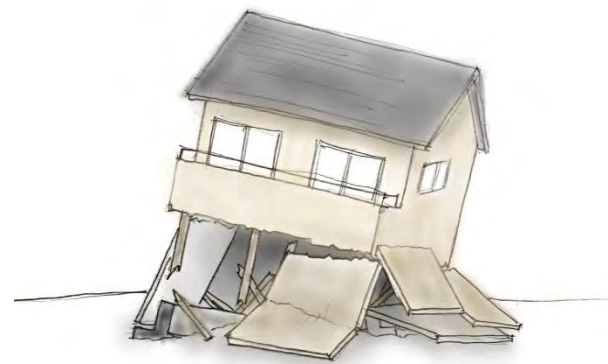
（基礎及び1階部分が崩れた住宅）
