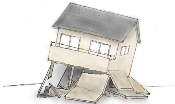
（基礎及び1階部分が崩れた住宅）
