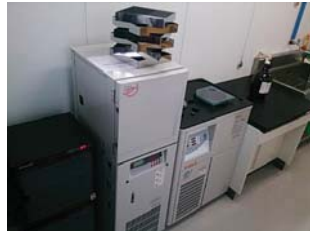
フリーズドライヤー設置
