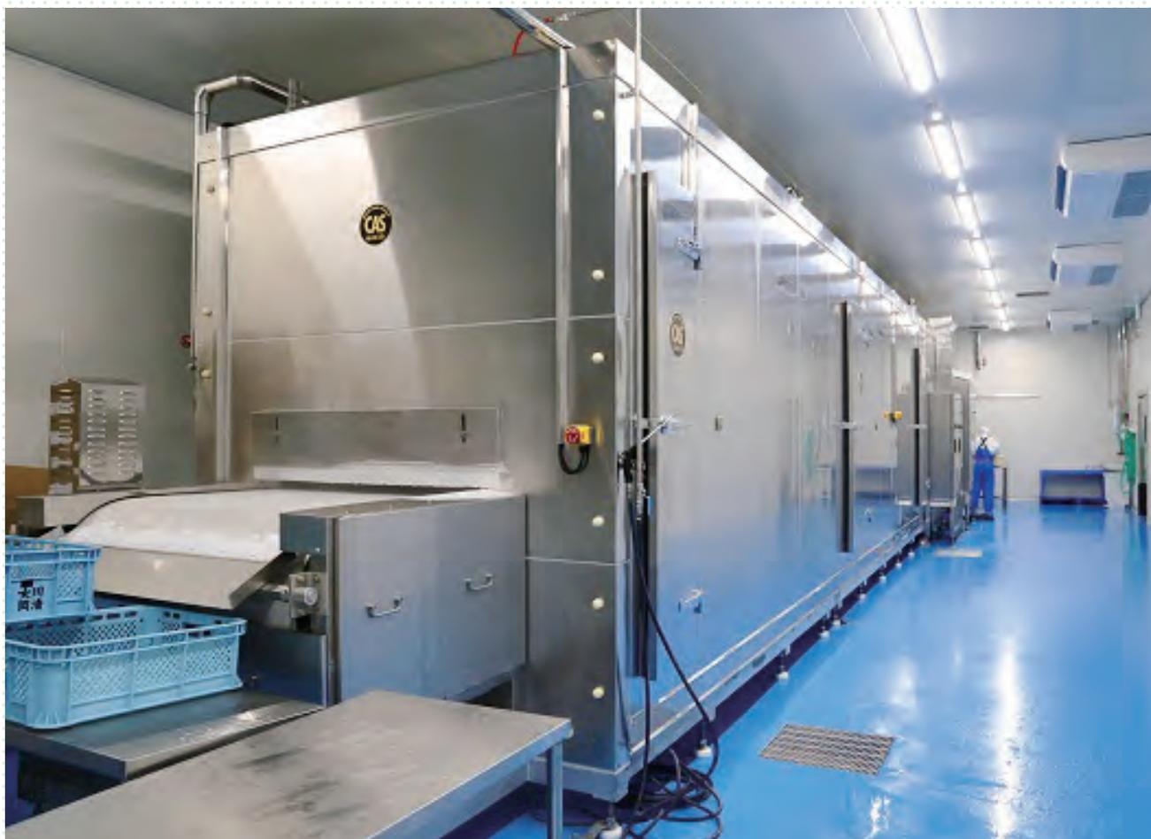
細胞破壊を抑える凍結技術＝CAS (Cells Alive Systems) 装置の導入
