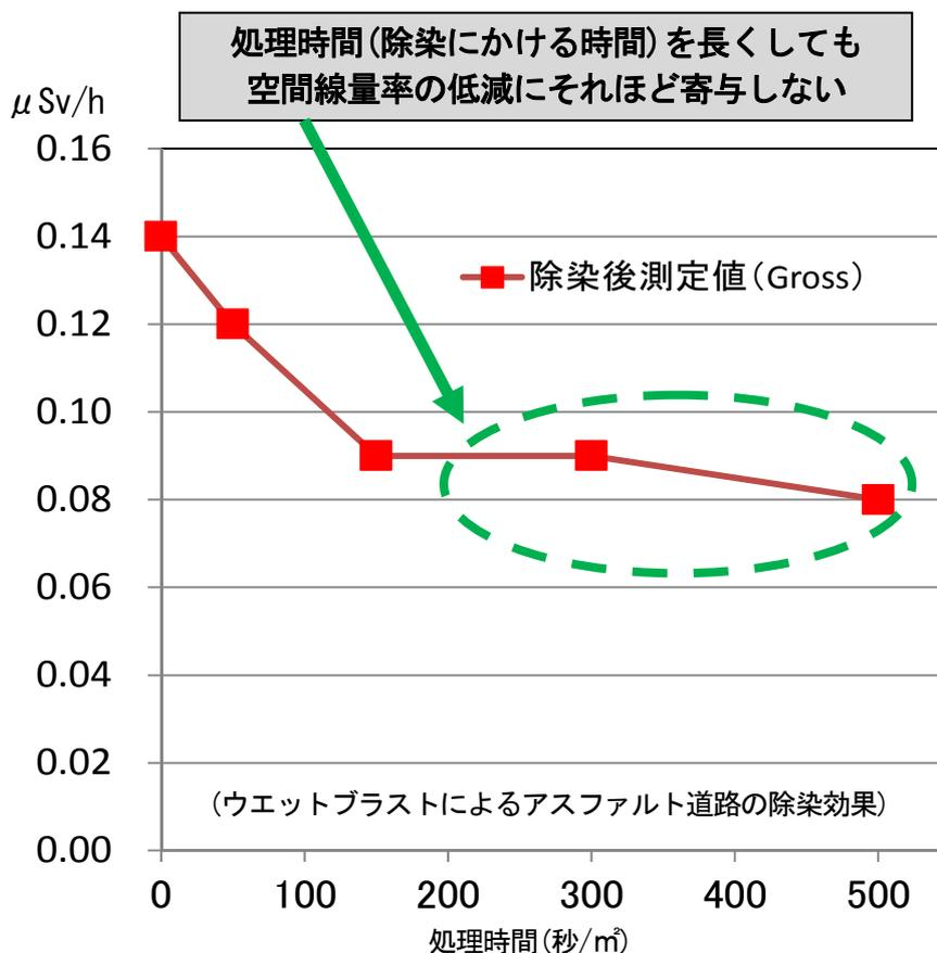
図 処理時間による空間線量率<sup>※</sup>の変化
