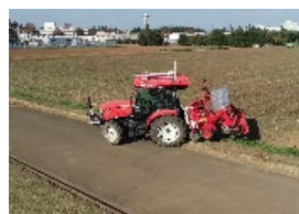
複数ほ場を自律的に移動・作業する完全無人自動走行システムを構築
