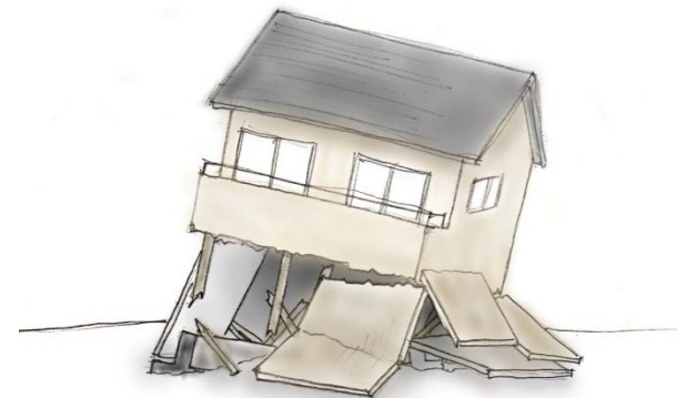
（基礎及び1階部分が崩れた住宅）
