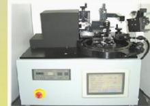
荷重変動型摩擦摩耗試験
