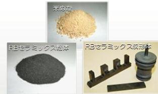
米ぬかを原料とする硬質多孔性炭素材料
