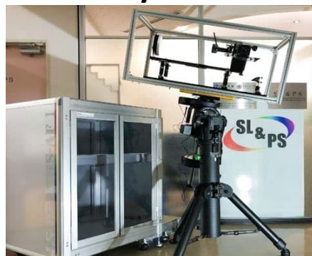
レーザーを用いた成分測定器 （出典：株式会社Smart Laser & Plasma Systems）
