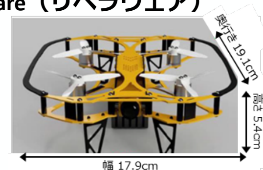
1号機原子炉格納容器内部を調査した際に使用したドローン（2024年2月～3月） （出典：株式会社Liberaware）
