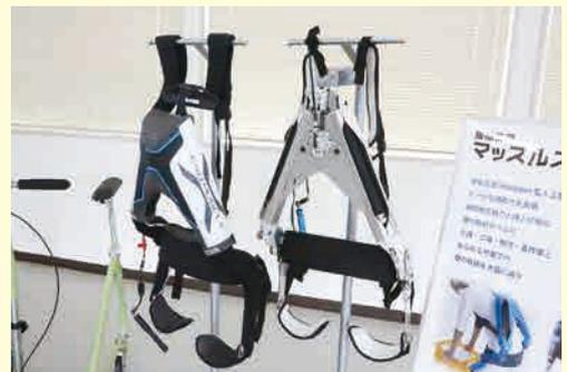
人工筋肉を用いて筋力をアシストすることで、身体への負担を軽減してくれる装着型の「マッスルスーツ」。より軽量化を図り、汎用化を目指している。
