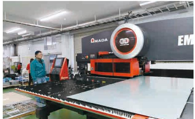
約240×120cmの巨大な鉄板に自動で型抜き、穴開け、曲げなどの加工ができる最新型機械。
