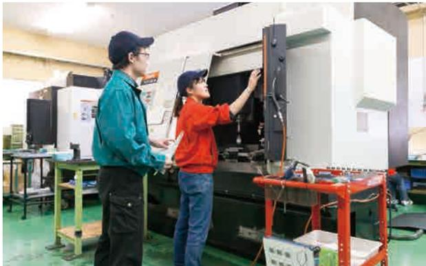
プログラムに従って穴開けや削り、仕上げ加工を行う「マシニングセンター」。プログラム担当者と操作担当者がパネルで確認を行う。
