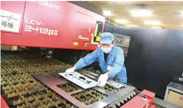
レーザー光線で金属板に穴を開け、切断、溶接を行う様子。最新鋭の機器を導入したことで作業時間も大幅に短縮された。
