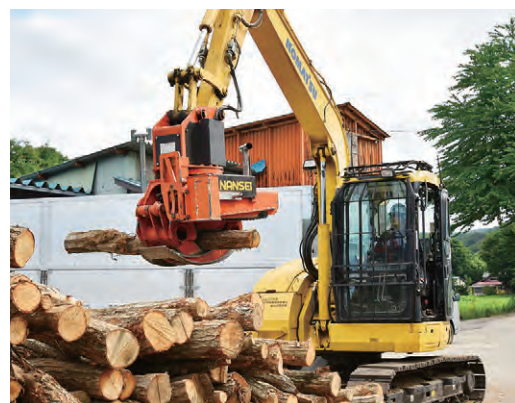
大型機械「グラップルソー」導入により、木材の運搬や積み込み作業が効率化された
