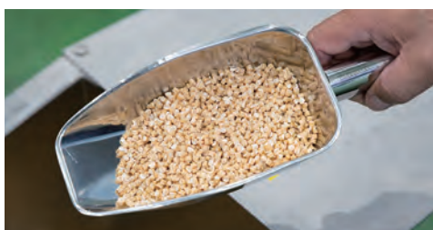
工場内で廃棄米、非食用米を生成してライスレジんに。駄菓子子の「ポン菓子」のような匂いがした
