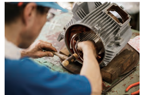
コイル巻き替え(巻き直し)や溶射施工などによって、幅広い故障に対応
