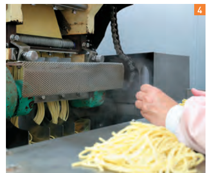
1 相馬工場の外観 2 ミキシングの工程 3 麺生地のを平らにする 4 薄くした麺生地のを機械で切り出す
