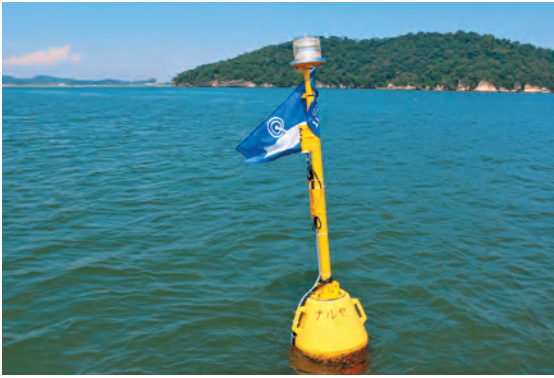
クラウドに測定データを送るため海上に設置しているブイ
