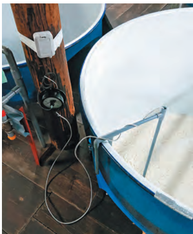
専用装置を開発し、センサーを用いて酒蔵の温度や湿度を管理
