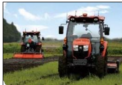
ロボットトラクタの無人自動運転による耕作
