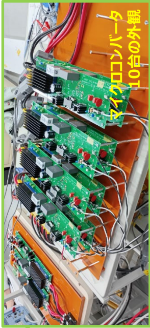
マイクロコンバータ10台の並列動作試験における結線
