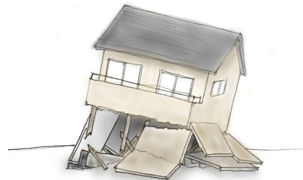
（基礎及び1階部分が崩れた住宅）
