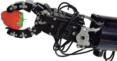
リアルハプティクス技術により、人の指先のような力加減で、遠隔操作ロボットがイチゴを優しく握る。
