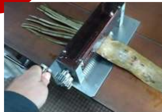
水に浸して柔らかくしてから 裁断機でヒゴを作る
