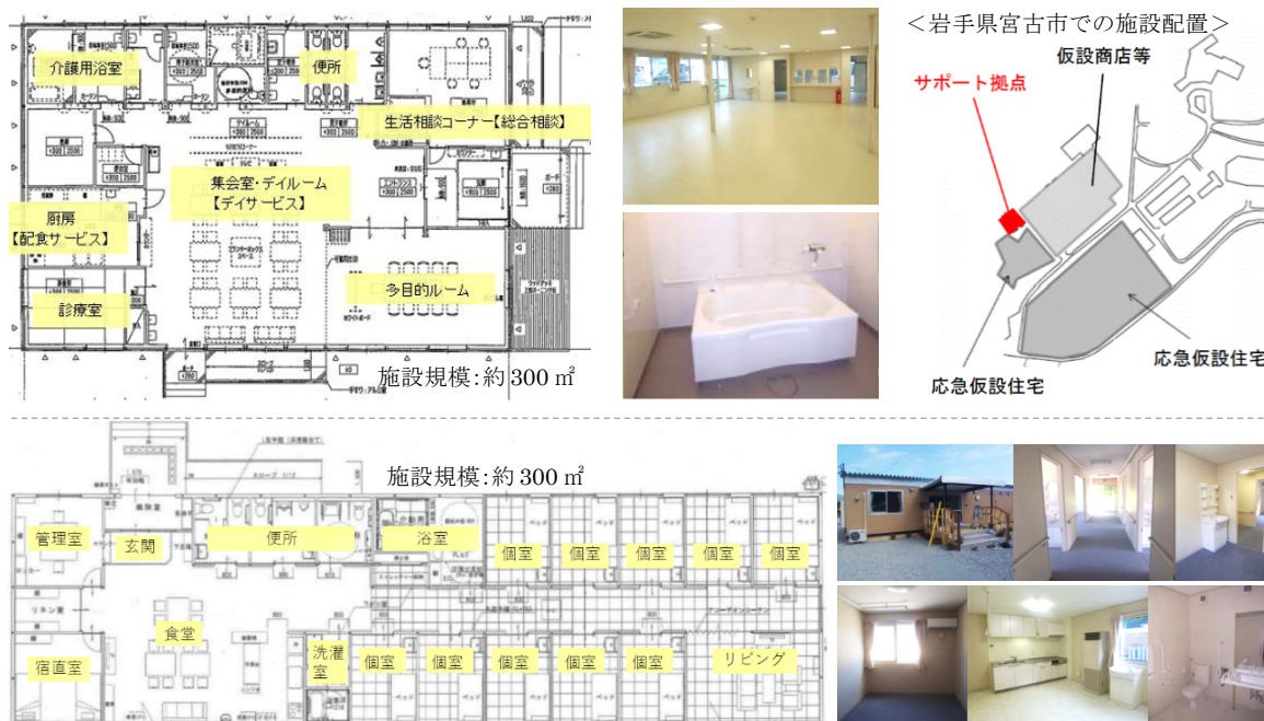
図1：岩手県のサポート拠点例（上）と福祉仮設住宅例（下）の平面図・写真等 （出典：国土交通省，岩手県県土整備部建築住宅課に一部追記）
