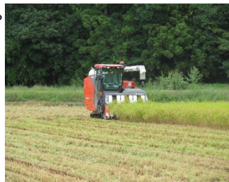
自動操舵機能を有したコンバインでの収穫作業
